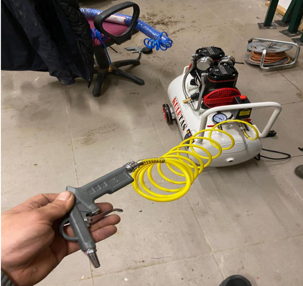
Oto yıkama alanına bar saatli hava basma makinası takılmış, pano baskıları tamamlanmıştır.
